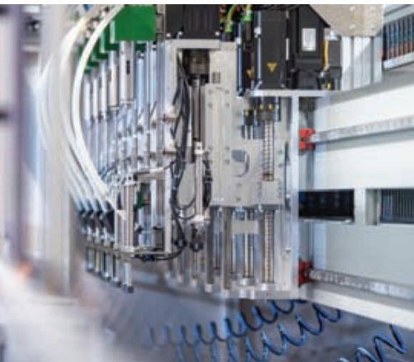
**Links:** Jede der fünf Bohrachsen ist mit einem »LeanMotor« von Stöber ausgestattet.
