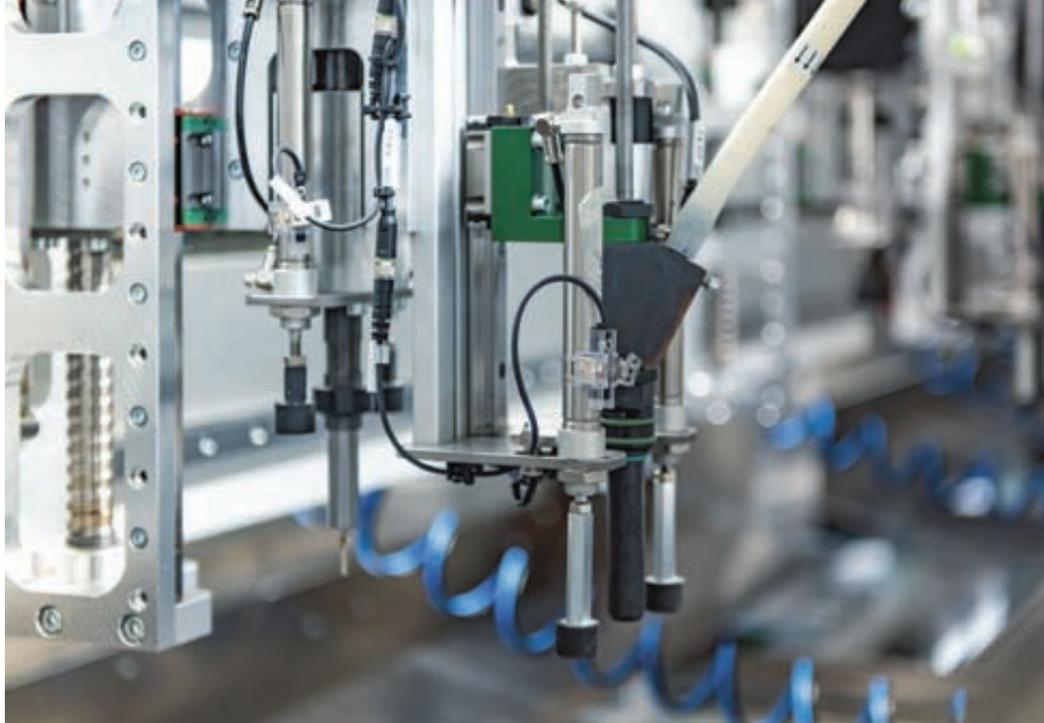
*Der Maschinenbauer Soga hat einen Schraubautomaten entwickelt, der verschiedene Schraubtiefen und Anschraubmomente überwachen kann.*
