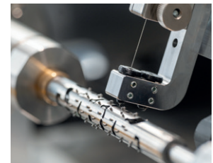
Wickeln des Nitinol-Drahts
